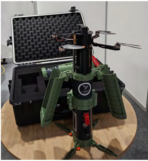
Dron DefendEye dedykowany dla policji lub straży pożarnej w konfiguracji do startu na tle pojemnika transportowego. Gotowość do startu osiąga w 10 sekund.
