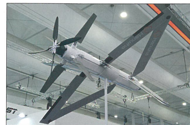
Bojovou náplňou perspektívnej riadenej rakety L-PGW 100 je vyčkávacja munícia. Na snímkach v letovej konfigurácii. V nose má pohyblivý optronický modul, v chvoste štvorlistovú tlačnú vrtuľu.
