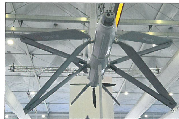
Bojovou náplňou perspektívnej riadenej rakety L-PGW 100 je vyčkávacja munícia. Na snímkach v letovej konfigurácii. V nose má pohyblivý optronický modul, v chvoste štvorlistovú tlačnú vrtuľu.
