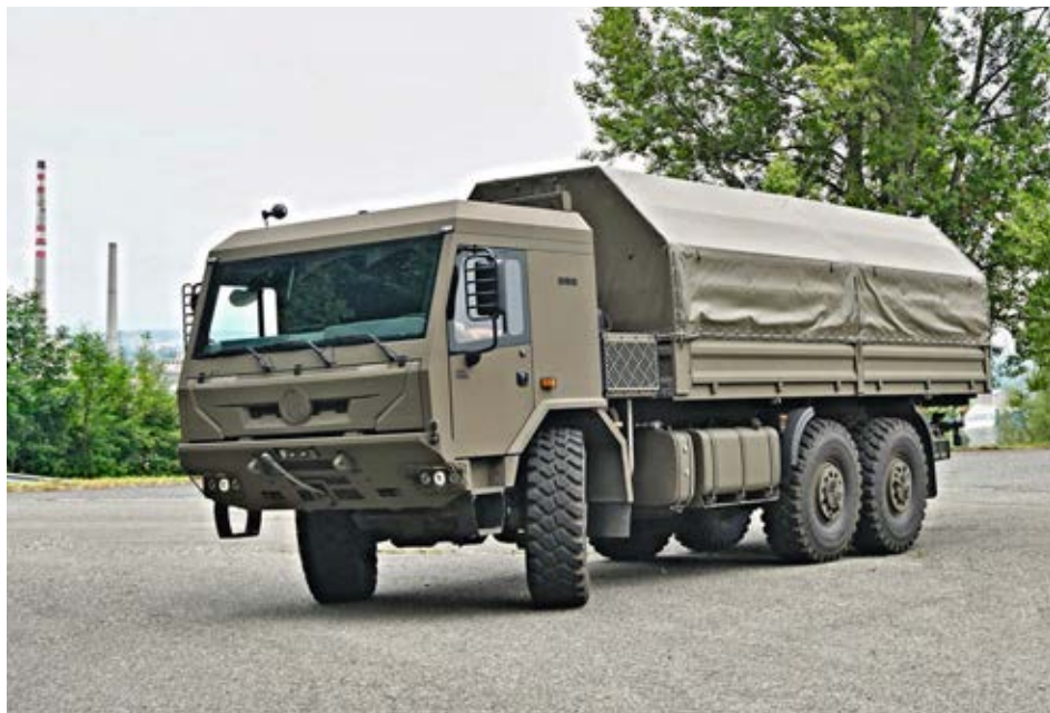
Tatra Force třetí generace je nejnovějším českým vojenským automobilem s typickým tatrováckým podvozkem s centrální nosnou rourou a nezávisle zavěšenými polonápravami. Foto: CSG
